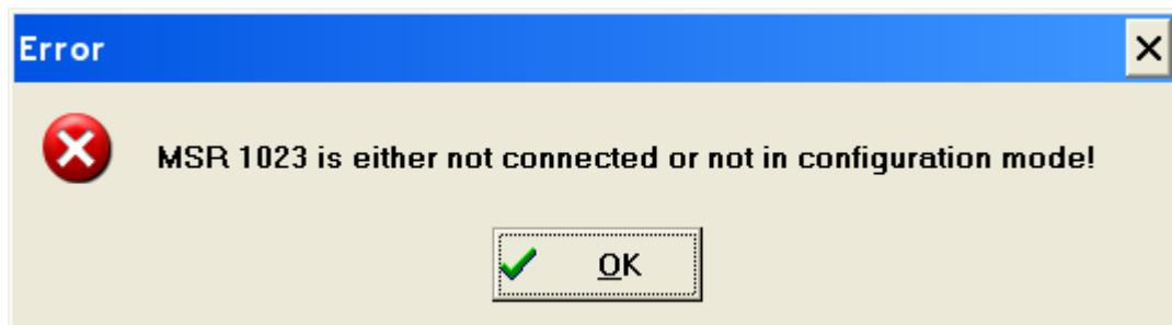
Для перевода устройства 1023 в режим конфигурирования, следует провести через считывающее устройство карточку управления. При переходе в режим конфигурирования, устройство 1023 подаст шесть последовательных звуковых сигналов.
